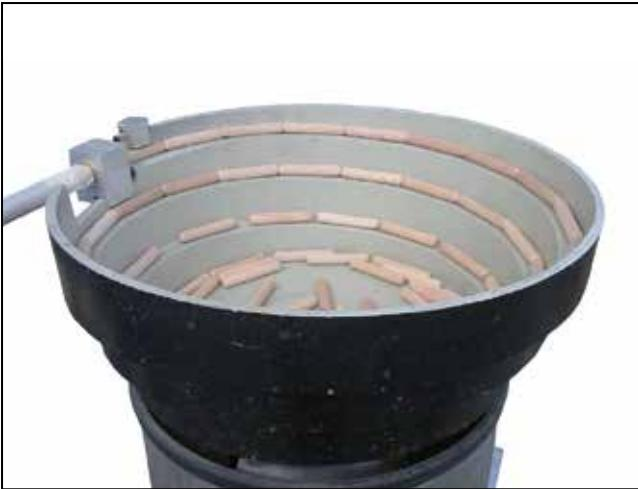
**La macchina è dotata di un caricatore vibrante che favorisce la continuità delle spine nella fase di incollatura, qualora il cliente ne sia già fornito, la macchina verrà consegnata senza caricatore.**
