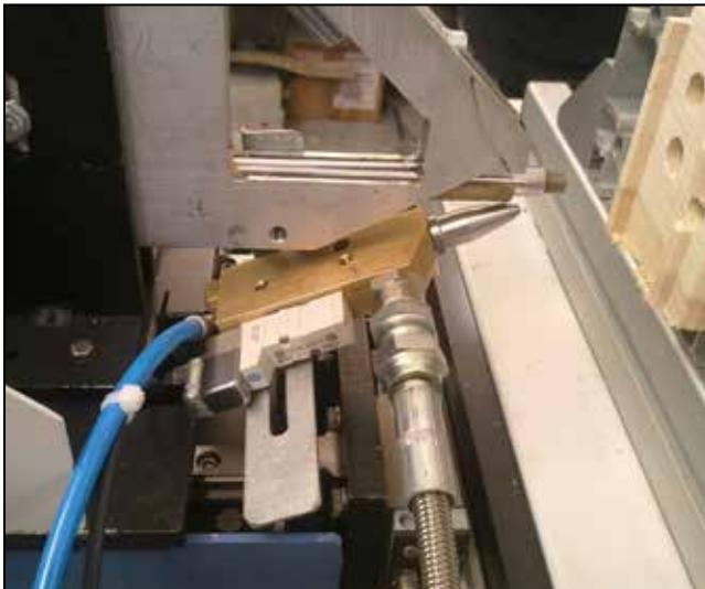
**Grazie al doppio effetto, l'iniettore elettropneumatico assicura una quantità precisa e costante di colla da introdurre nel foro prima dell'inserimento della spina. La quantità di colla e il tempo di apertura e chiusura dell'iniettore, sono regolabili a seconda delle proprie esigenze.**
